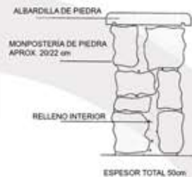
MURETE DE PIEDRA CON MAMPOSTERÍA
