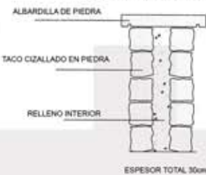
MURETE DE PIEDRA DE TACO CIZALLADO O NATURAL A DOS CARAS
